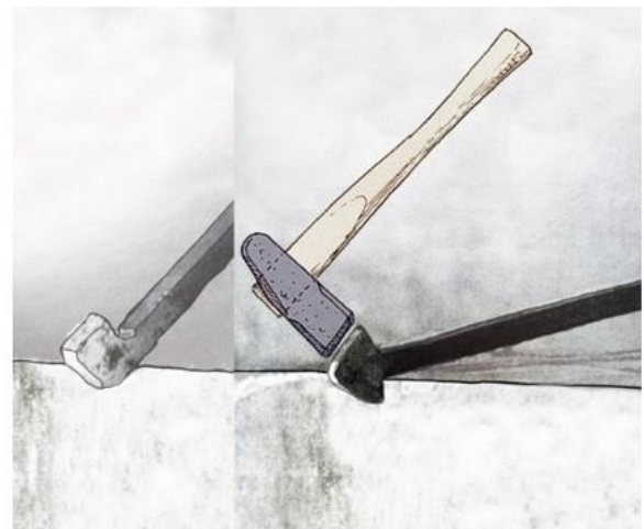
Schmieden des Kopfes eines Leistnagels auf der Ambosskante 14
