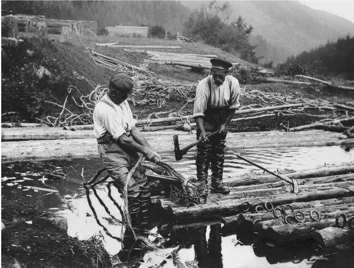
Abbildung 1 Flößer beim Anbinden bei der Rehmühle um 1910. Foto: Karl Blumenthal (1866–1944). Gemeinfrei https://de.m.wikipedia.org/wiki/Datei:Karl_Blumenthal_Fl%C3%B6%C3%9Fer_Anbinden.jpg (14.01.2021).
